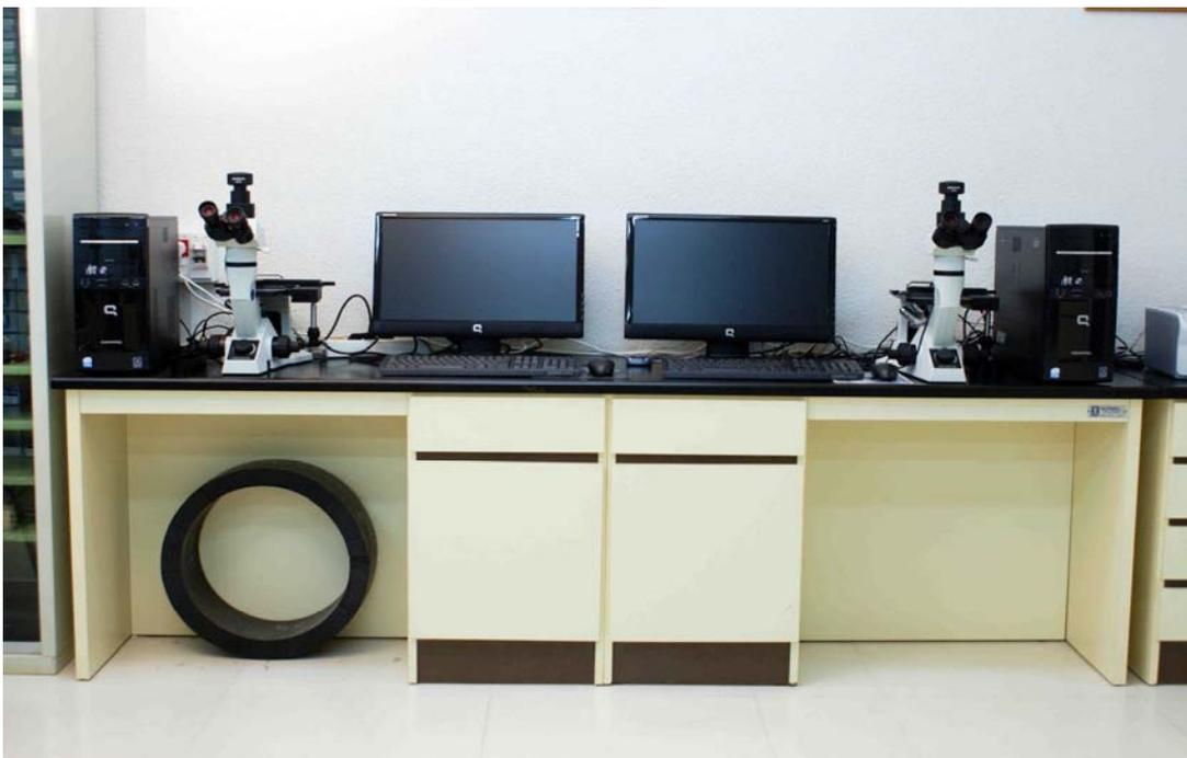
Microscopios metalográficos electrónicos.
