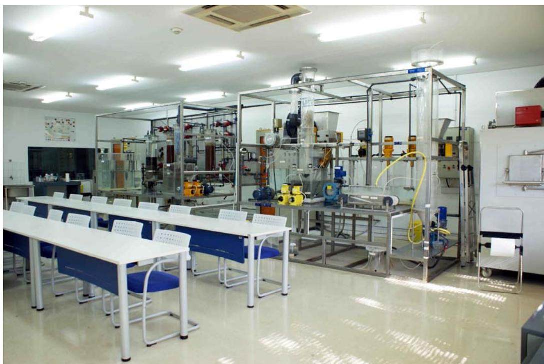
Plantas Piloto de: Tratamiento y Desmineralización de Agua, de Lavado de Gases y Cámara de Pirólisis.
