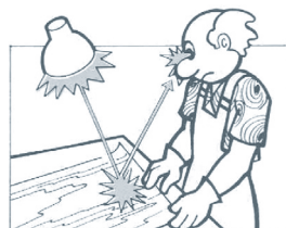
DESLUMBRAMIENTO POR REFLEJOS EN LA SUPERFICIE DE TRABAJO
