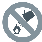
Prohibido apagar con agua
